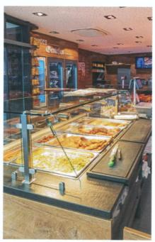
Zwei Wärmequellen – eine Glaskeramikplatte und ein Wärmestrahler – sorgen für eine trockene und kompakte Wärme.
